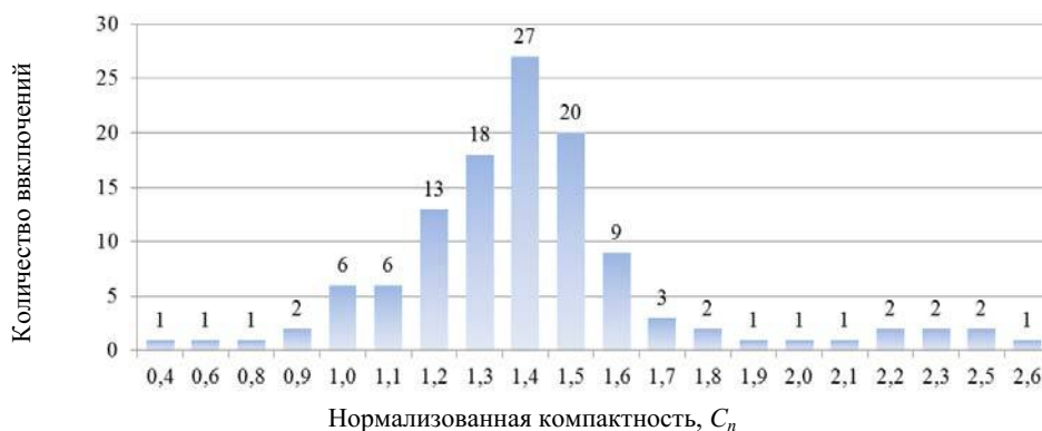
Рис. 3. Гистограмма распределения включений графита по нормализованной компактности
