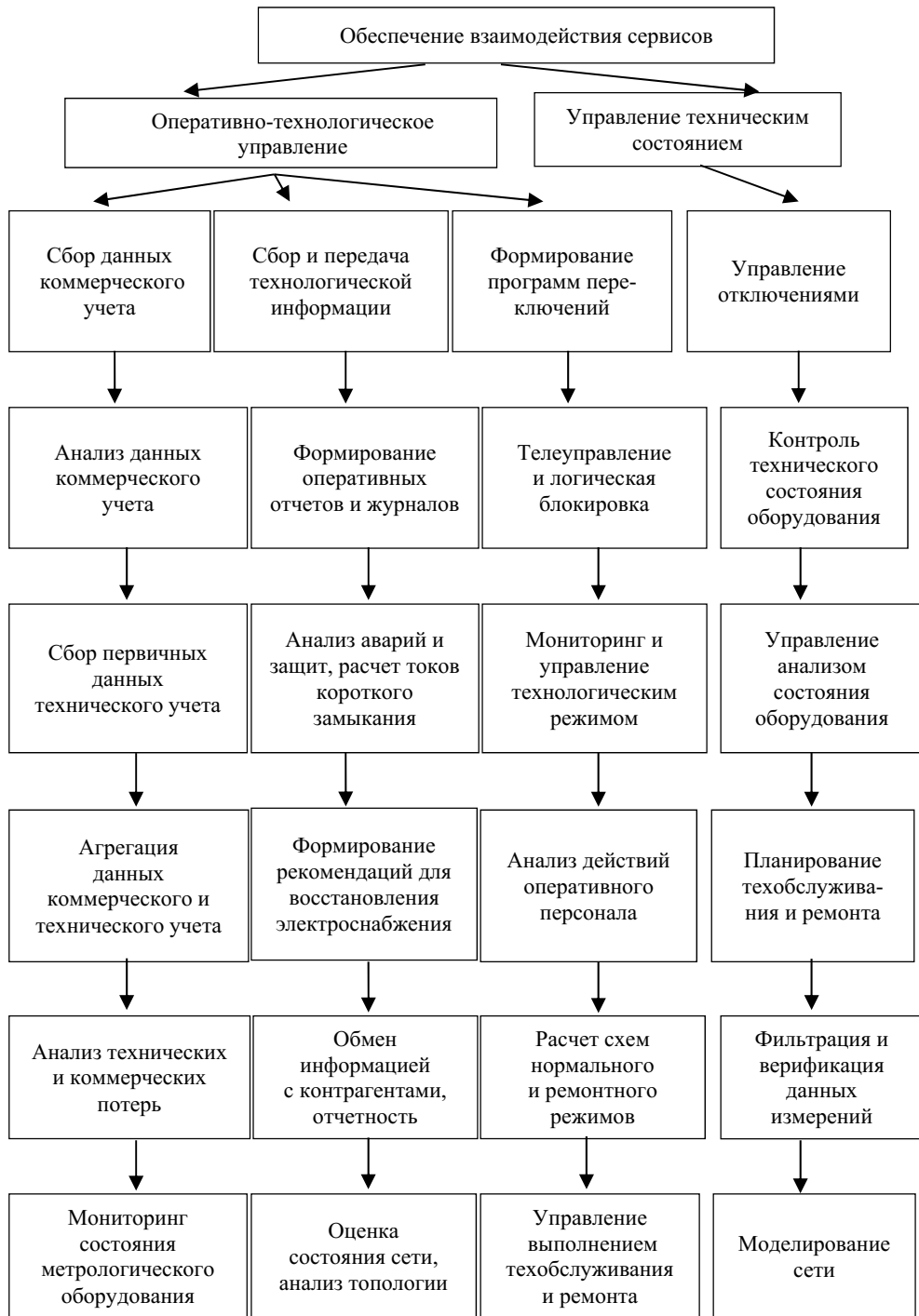
Рис. 1. Структура корпоративной информационной системы управления сетевой компании КИУС обеспечивает два основных сервиса: оперативно-технологическое управление и управление техническим состоянием электросетевого комплекса
