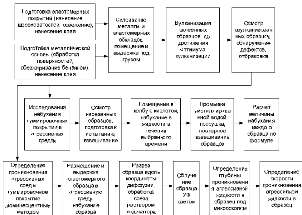
Рис. 3. Методика проведения экспериментов по исследованию химической стойкости гуммировочных покрытий в агрессивных средах
