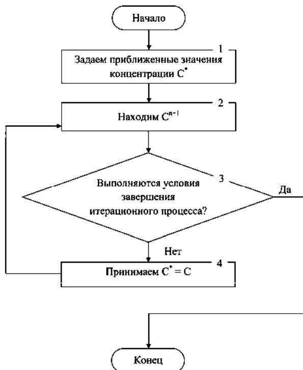
Рис. 3. Алгоритм численного решения уравнения диффузии активного вещества в вихревом потоке жидкости
