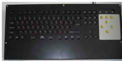
Рис. 9. Клавиатура с накладкой и кнопочной мышью с расположением кнопок справа
