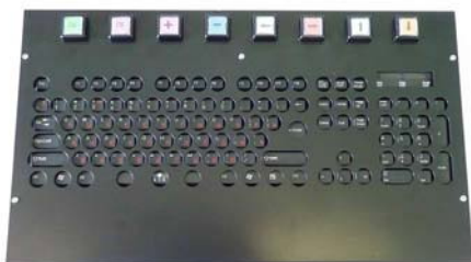
Рис. 8. Клавиатура с накладкой и кнопочной мышью с расположением кнопок сверху
