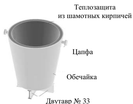
Рис. 1. Конструкция ковша для транспортировки штейна
