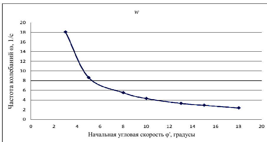
Рис. 7. Зависимость между частотой колебаний модуля и начальной угловой скоростью при различных значениях начального отклонения
