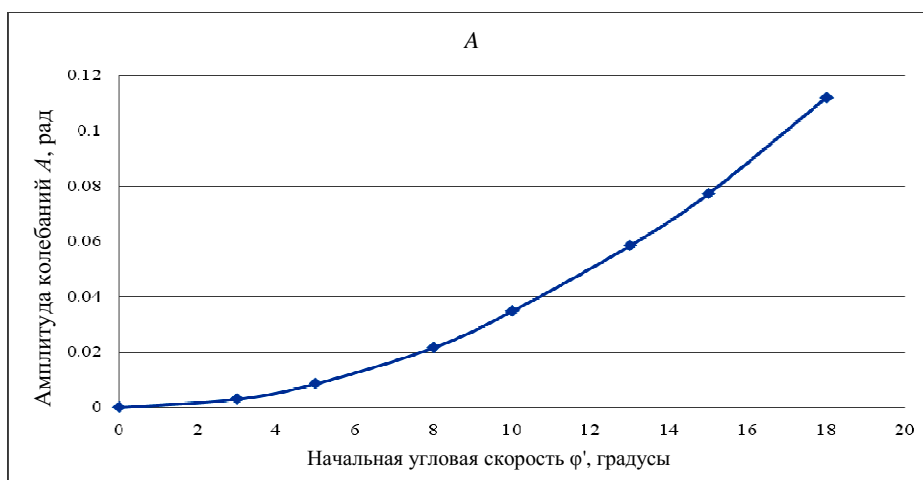
Рис. 8. Зависимость между амплитудой колебаний модуля и начальной угловой скоростью при различных значениях начального отклонения
