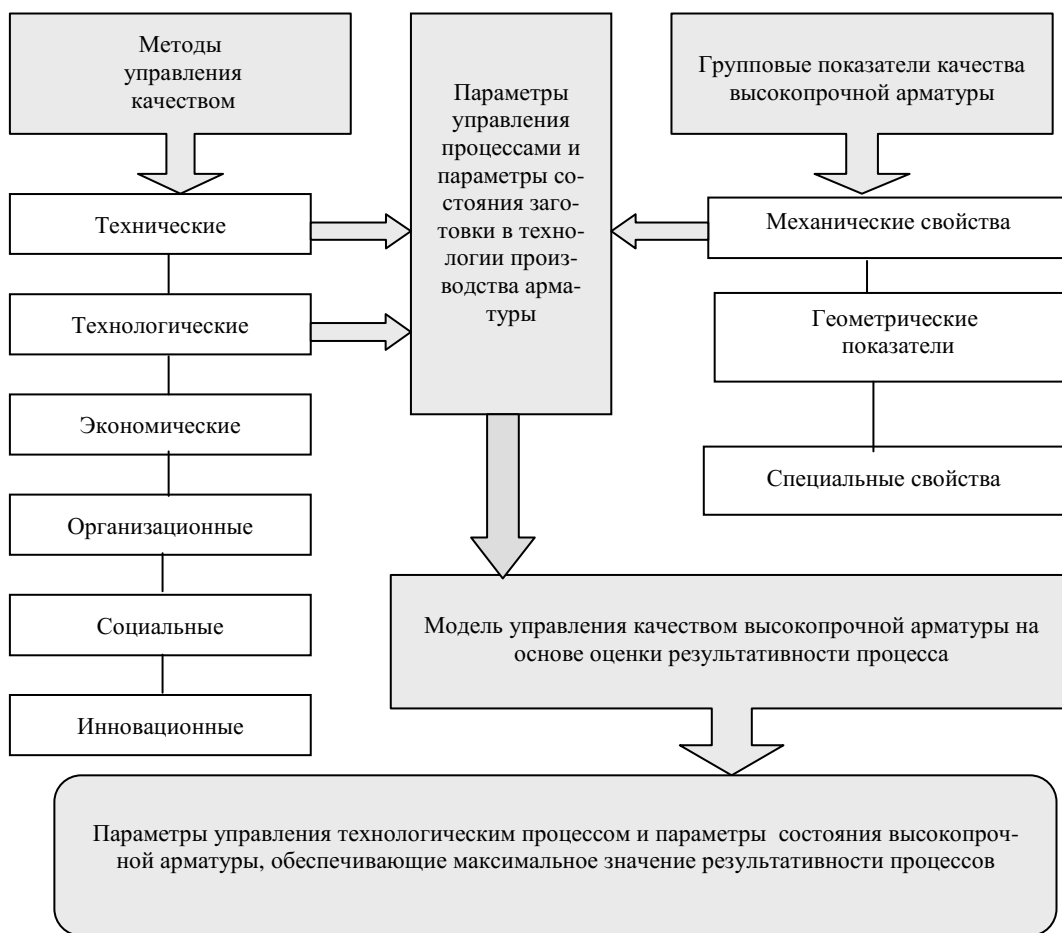
Рис. 2. Функциональная блок-схема решения задачи, обеспечивающей повышение результативности технологического процесса производства арматуры
