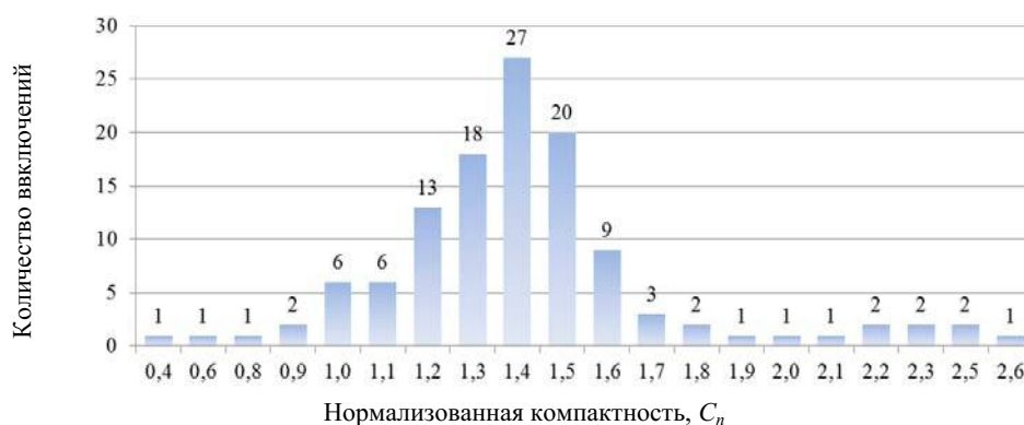
Рис. 3. Гистограмма распределения включений графита по нормализованной компактности
