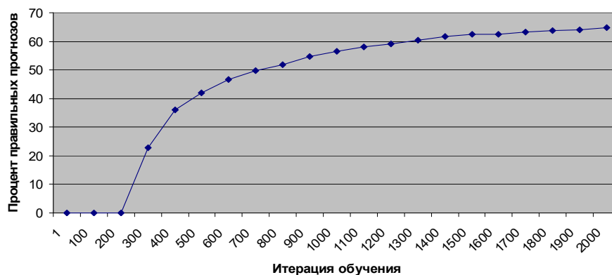
Рис. 4. График повышения обученности сети в процессе адаптации весовых коэффициентов
