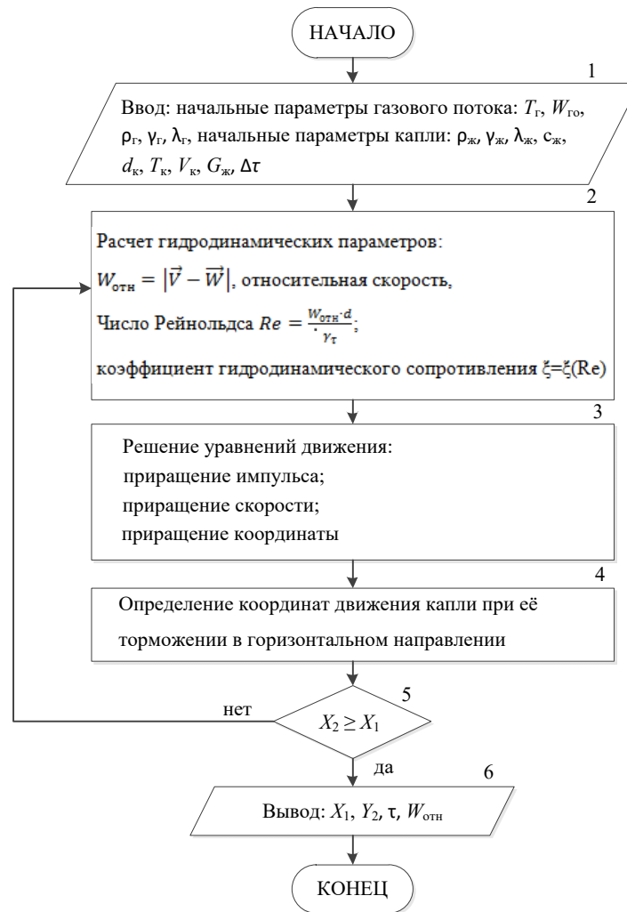
Рис. 3. Алгоритм расчета траекторий движения жидкой капли доменного шлака и оценка траектории движения
