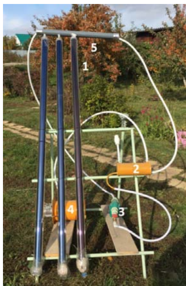
Рис. 1. Экспериментальный стенд выработки электрической энергии за счет использования солнечной энергии: 1 – солнечные коллекторы, 2 – опреснитель, 3 – циркуляционный насос, 4 – тепловая турбина и генератор, 5 – теплообменник
