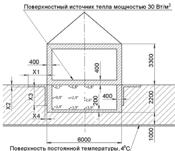
Рис. 1. Схема фундамента: температура в девяти точках до оптимизации теплоизоляции (размеры указаны в миллиметрах)
