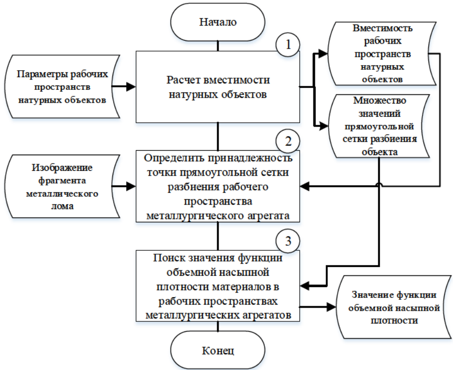
Рис. 4. Функциональная схема модуля построения функции объемной насыпной плотности
