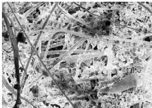
Рис. 2. Внешний вид твердых частиц, отобранных на котлоагрегате №2
