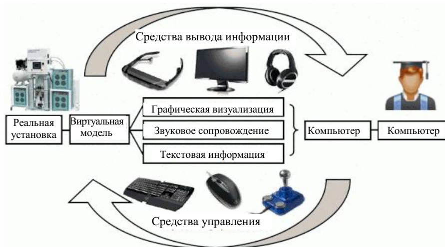
Рис. 1. Схема процесса обучения с помощью компьютерного тренажера
