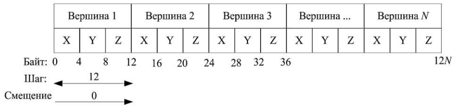
Рис. 5. Схема структуры хранения информации о координатах вершин полигональной сетки
